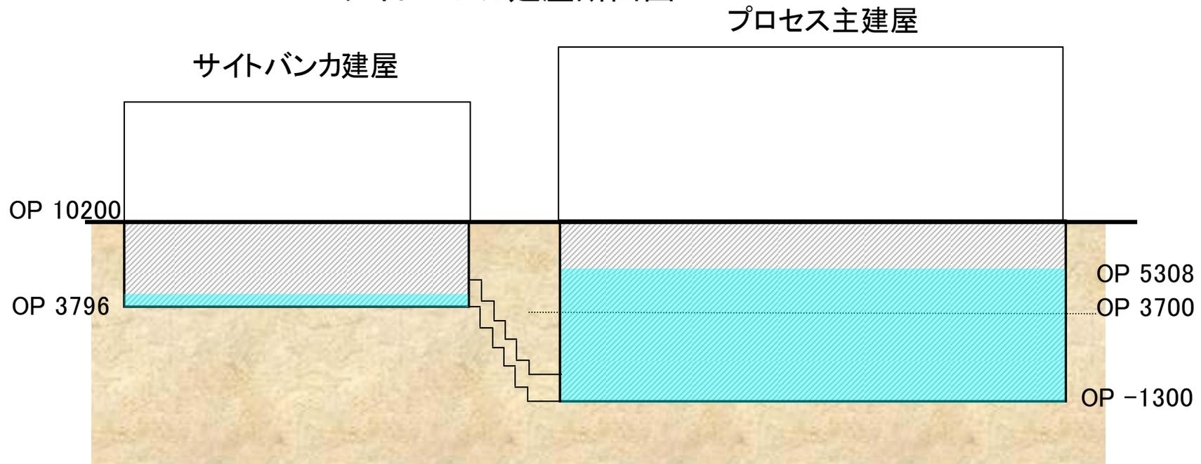
サイトバンカ・プロセス主建屋位置関係図(A-A断面図)
