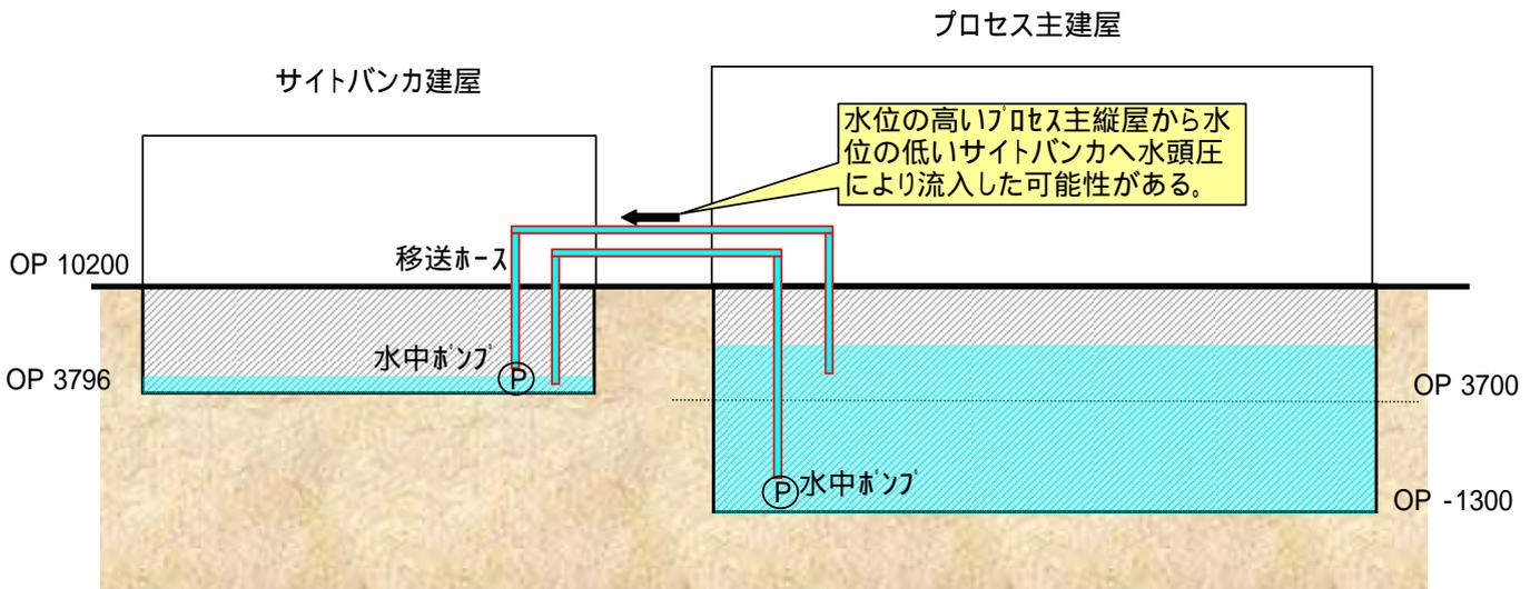
サイトバンカー・プロセス主建屋位置関係図(A-A断面図)
