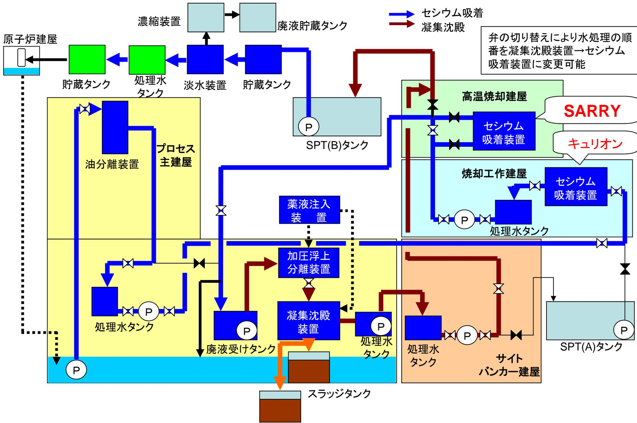
水の流れ: プロセス主建屋 → 油分離装置 → セシウム吸着装置 → 凝集沈殿装置 → 淡水装置
