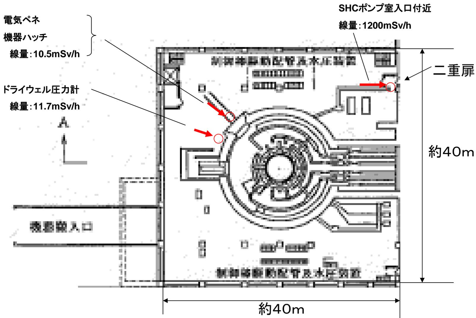
1号機原子炉建屋1階平面図
