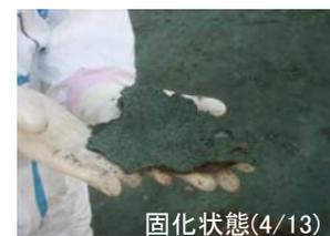
写真-2: 固化状態の確認試験結果(4/1散布実施箇所)
