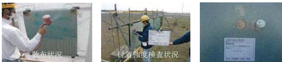
写真-5 散布状況と付着強度検査状況(鉄板面)
