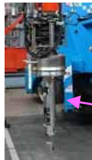
グラップル (マスト先端据付状態)
