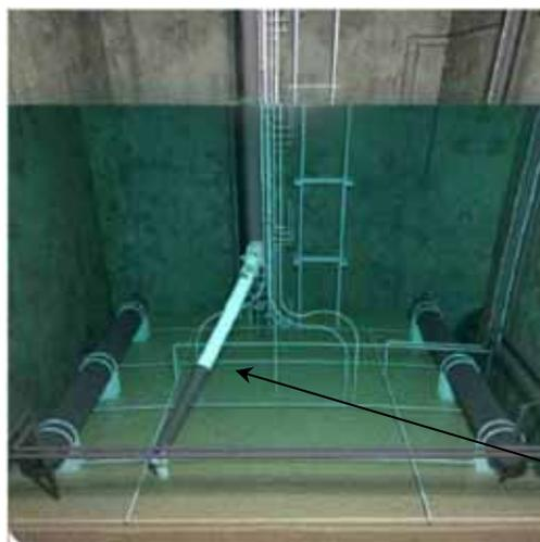
貯槽D内の遠隔操作アーム稼働イメージ
