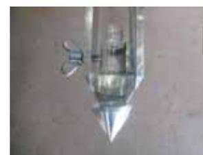
調査用治具の先端構造
