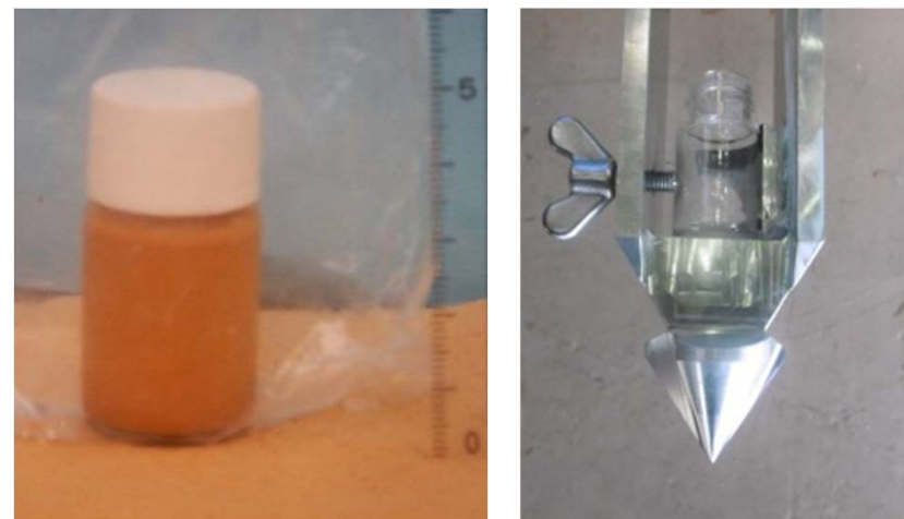
10ml バイアル瓶の取付け状態(右)と 回収されたAREVAスラッジ(左)
