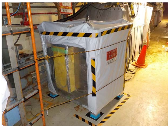
小型ミュオン測定装置 (約1m×1m×高さ1.3m)
