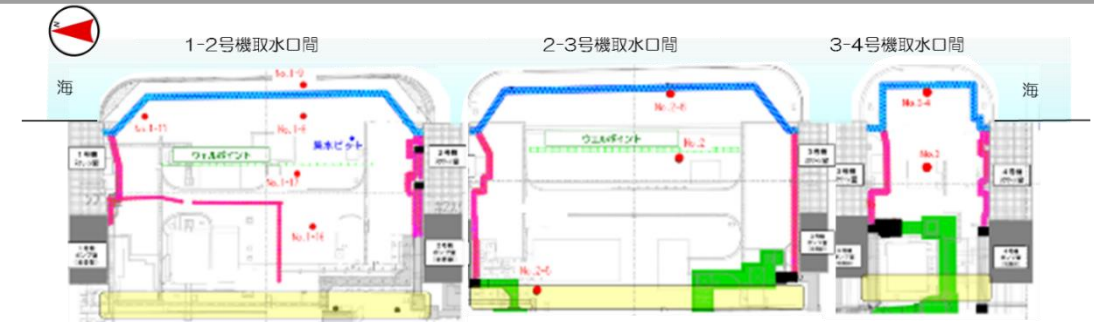
水ガラスによる地盤改良施工箇所
