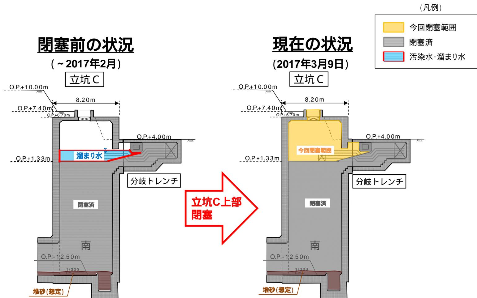
立坑C閉塞の概要図(立坑C南の断面図の例)
