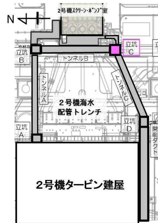
2号機海水配管トレンチ平面図
