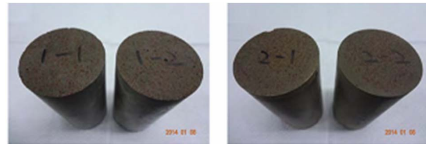
加熱後スラッジのセメント固化体 (左：充填率40%、右：充填率50%)
