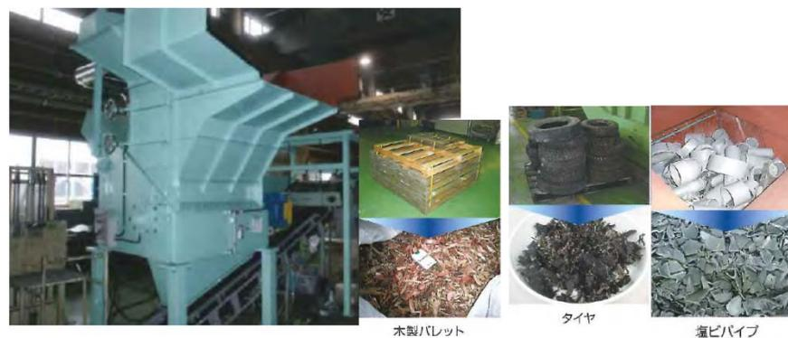
瓦礫類中の可燃物の破碎装置 例
