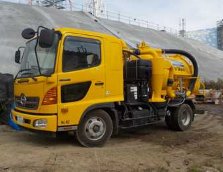
排水路清掃に使用するバキューム車
