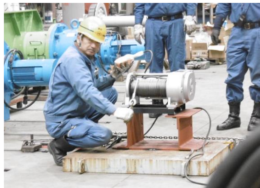
牽引治具を操作している様子
