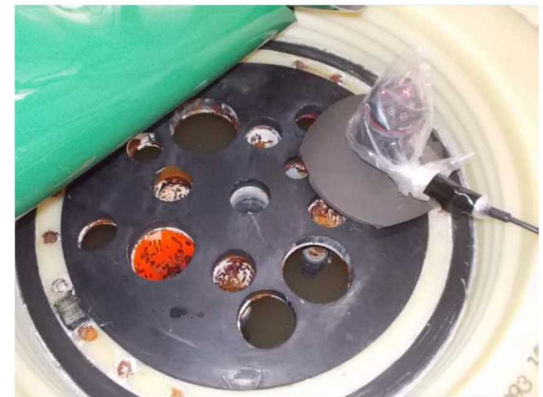
液位計による液位観察状況
