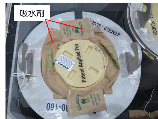
(b) 吸水剤の設置状況
