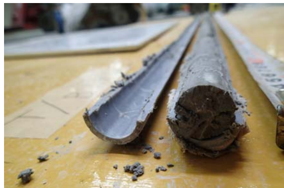
貫通部を模擬した塩ビ管内の充填状況
