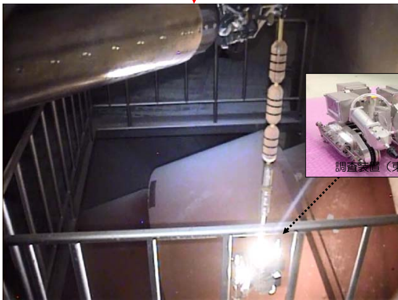
2号機 実機調査状況 (調査装置の吊り降ろし)
