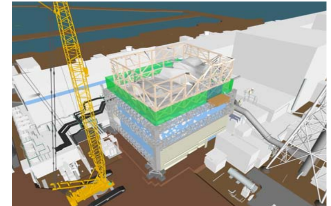
⑥建屋カバー解体完了 ⇒その後、ガレキ撤去作業に移行
