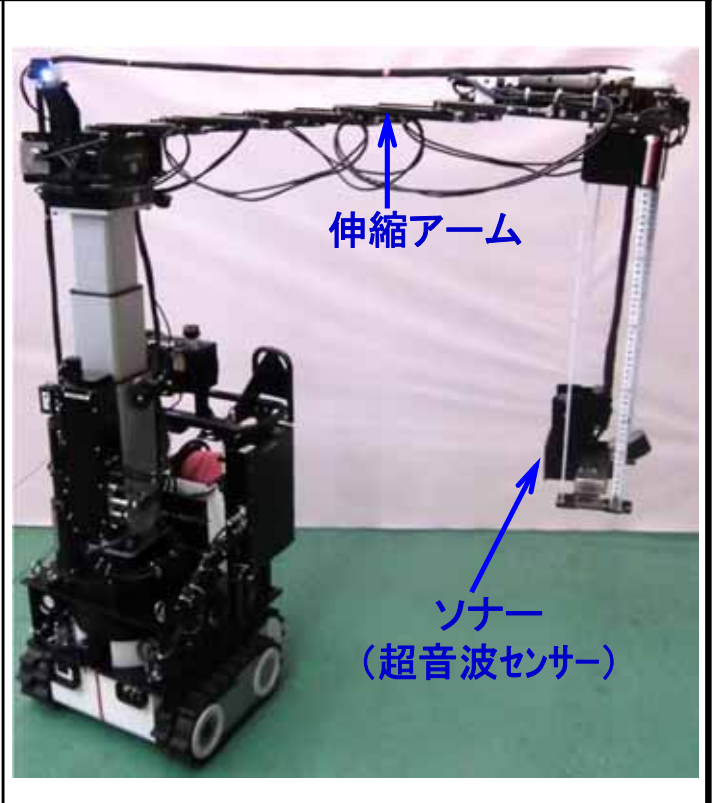
③トーラス室壁面調査 (ソナーによるドップラ計測画像取得)
