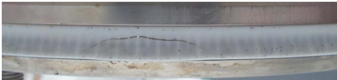
CFF7AVシールの側面 * 割れは取り外し時に発生したもの
