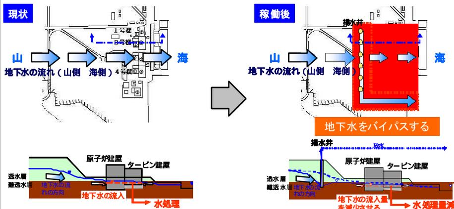
地下水は、山側から海側に向かって流れております。その地下水の一部が建屋内に流入し、汚染水が増加しています。建屋内へ流入する地下水を少なくすることを目的に、建屋よりも上流で井戸を掘り、揚水して、地下水の流路を変更する「地下水バイパス」を計画しています。
