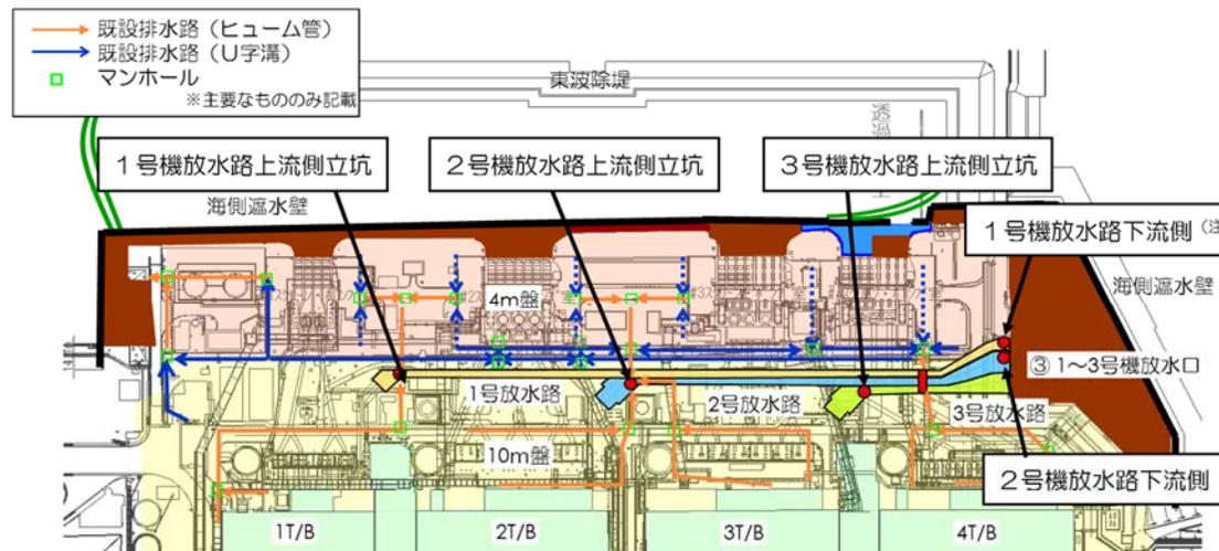
注：ゼオライト土のう設置（2月）以降、放水口から下流側立坑へのアクセス不可のため、放水口上部より採水
