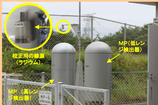
モニタリングポストへの校正用線源の照射
