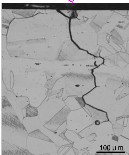
粒界に沿って発生したひび(断面図)
