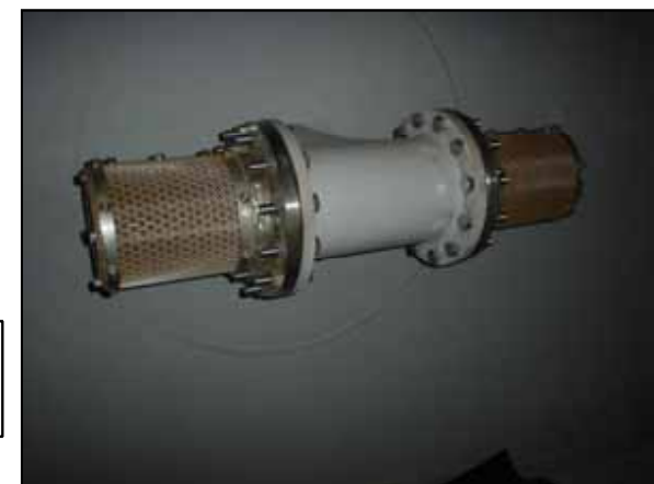
原子炉隔離時冷却系ストレーナ
