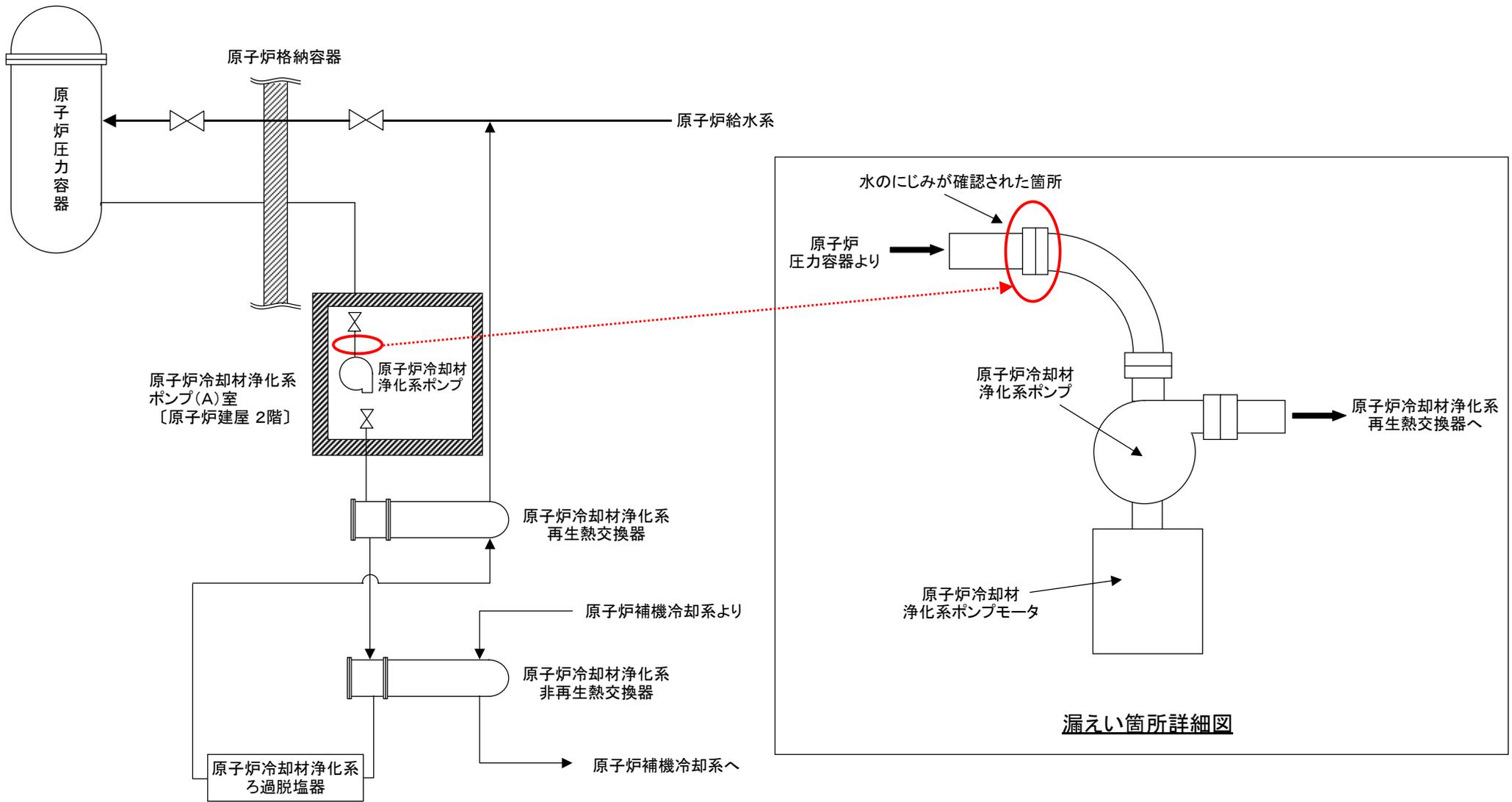
1号機 原子炉冷却材浄化系 概略図
