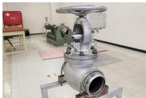
分解点検研修に使用する弁
