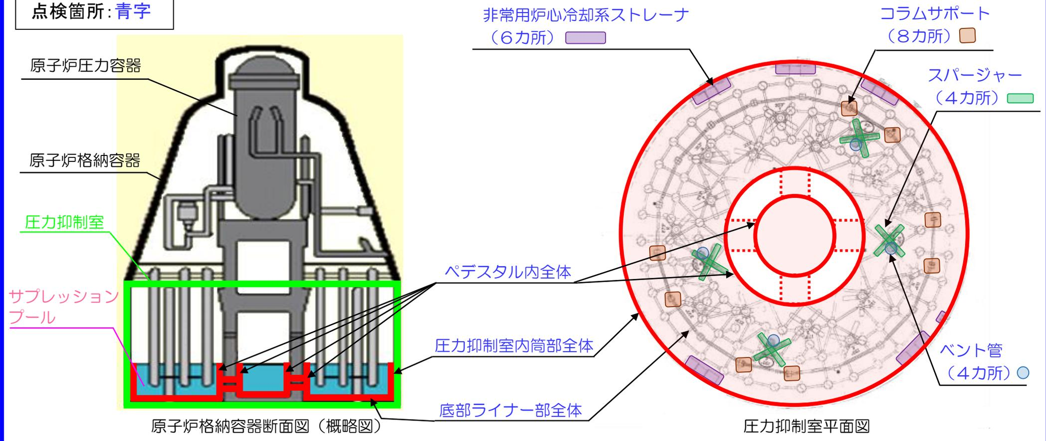
※LEDハンディライト：圧力抑制室のサプレッションプール水温度検出器の点検で使用したLEDハンディライト（仮設で準備した作業用照明）が、圧力抑制室に落下した可能性があることを公表しています。
