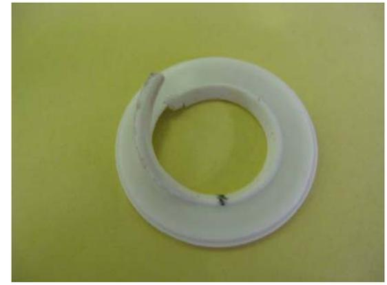
損傷したテフロン製弁シート
