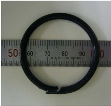
破損したパッキン
