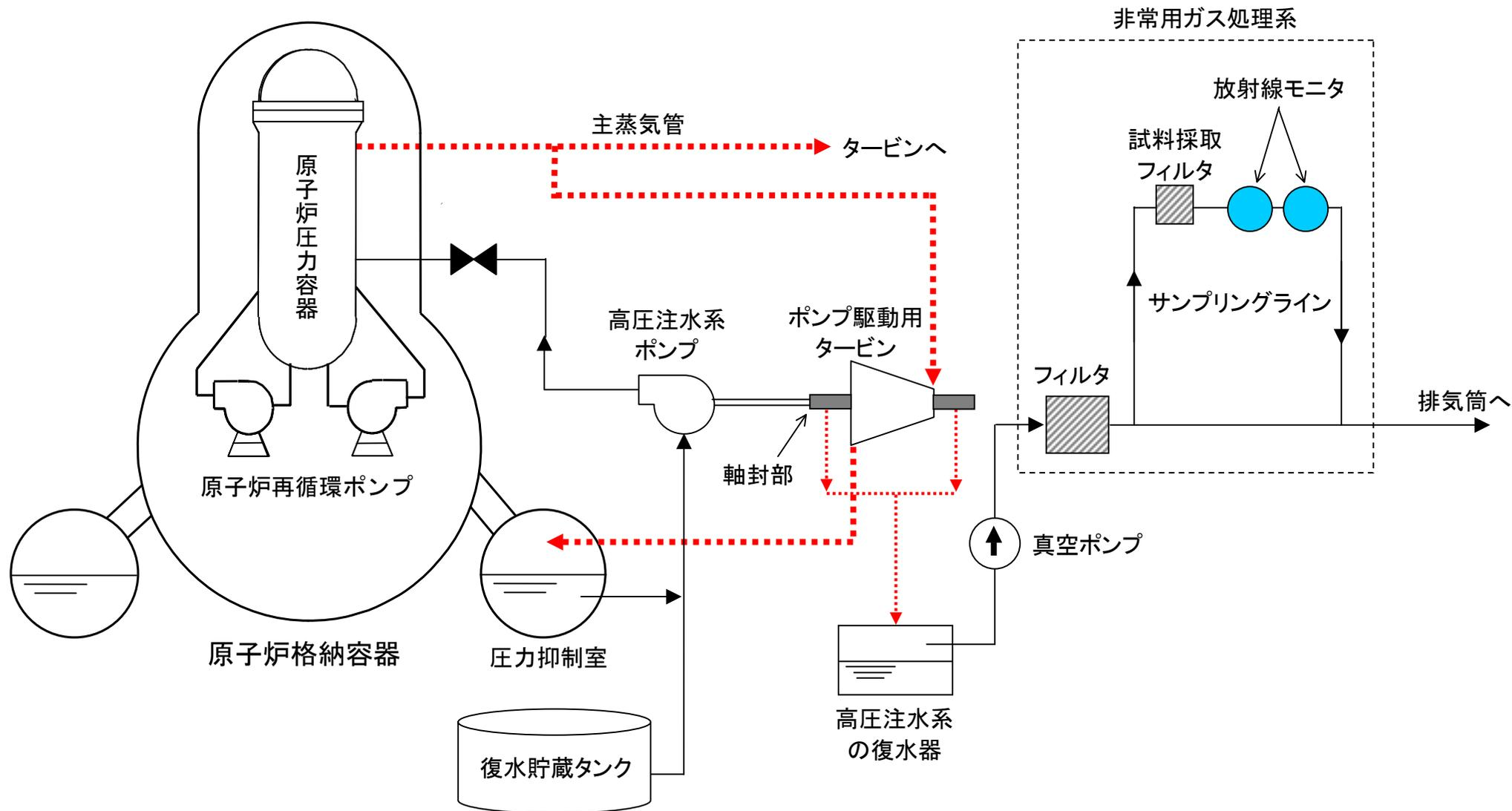
4号機高圧注水系および非常用ガス処理系概略図
