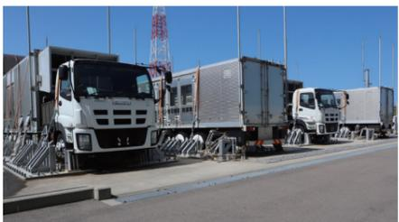
軽油の燃焼ガスでタービンを回して電気を作る発電機を搭載した車両。送電線からの電気や非常用ディーゼル発電機が使用できない場合の代替電源として、7号機構や海抜21mの高台に分散して配置しています。
