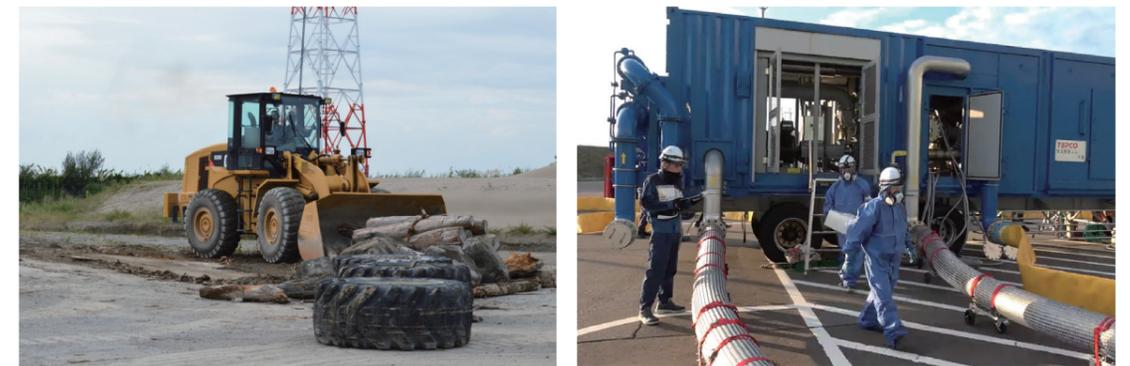
緊急時にも正確かつ速やかに動かせるようにするため、ホイールローダによるガレキ撤去（左）や代替熱交換器車の接続（右）など、可搬型設備の操作・接続訓練を日々行っています。
