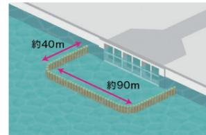
津波による引き波が発生した際にも冷却用の海水を確保するため、取水口の海側に貯留堰を設けています。
