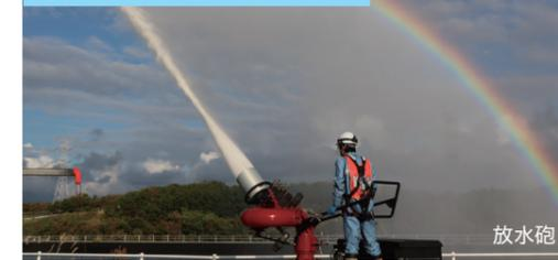
原子炉や使用済燃料プール内から放射性物質が放出される恐れがある場合、放水砲と大容量送水車を接続し原子炉建屋の開口部に放水します。大容量送水車は、最大で毎分2万リットル送水でき、タンクローリーからの燃料補給で連続運転が可能です。タンクローリーからの燃料補給が受けられない場合は、送水車に付属している燃料タンクを用いることで約12時間放水を継続できます。
