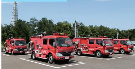
原子炉建屋に接続し、原子炉や使用済燃料プールに注水を行います。同時に使用不能とならないよう、分散配置しています。
