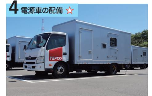
プラントの交流電源が失われた際に、重要機器へ電源を供給します。機動性に優れ、必要なときに必要な場所へ移動して電気を供給できます。
