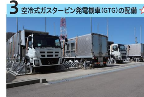
軽油の燃焼ガスでタービンを回して電気を作る発電機を搭載しています。発電所構内の津波の影響を受けない場所に配置しています。
