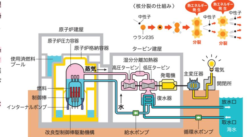
※改良型沸騰水型原子炉 (6～7号機) の例
