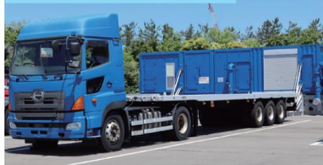
既存の除熱設備が使えなくなった場合に、原子炉や原子炉格納容器内を冷やす設備です。これを用いることで、少なくとも約10日間は大気への放射性物質の放出を遅らせることができます。
