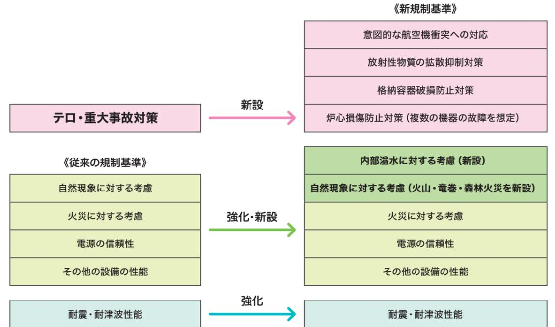
新設された「テロ・重大事故対策」については、例えば、意図的な航空機衝突などにより、原子炉を安全に保つための電源や注水機能が失われた場合でもバックアップできるように、体制や手順書を整備するとともに、さまざまな役割の可搬型設備を配備し、緊急時に動かせるよう日々訓練を行っています。
