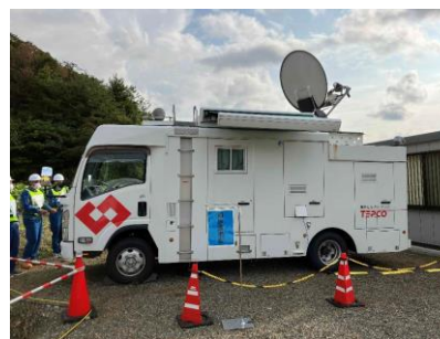
衛星通信車の設置訓練
