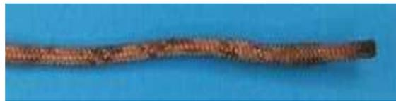
分解したケーブル（外側の導体の酸化）
