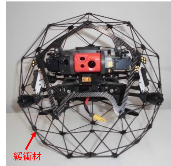
点検に使用するドローン
