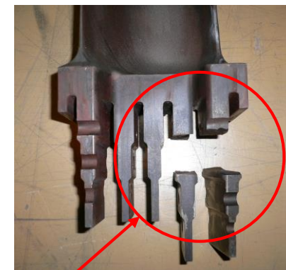
第14段動翼の損傷状況（折損）
