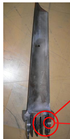
第14~16段 動翼の構造 (付根部:フォーク型)
