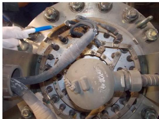
電気ヒータの焼損部（除湿装置上面）
