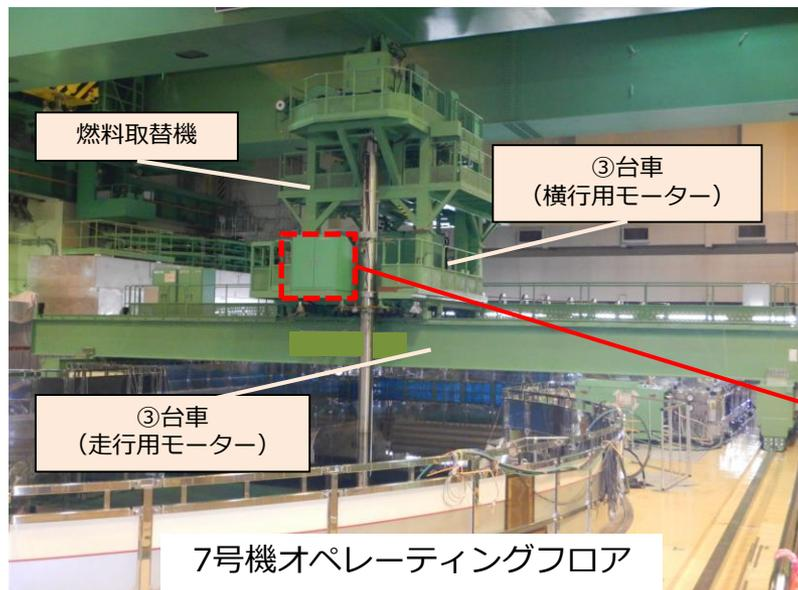
燃料取替機は原子炉と使用済燃料プールとの間を移動し、原子炉からの燃料取り出しおよび、原子炉への燃料を装荷する際に使用する設備
