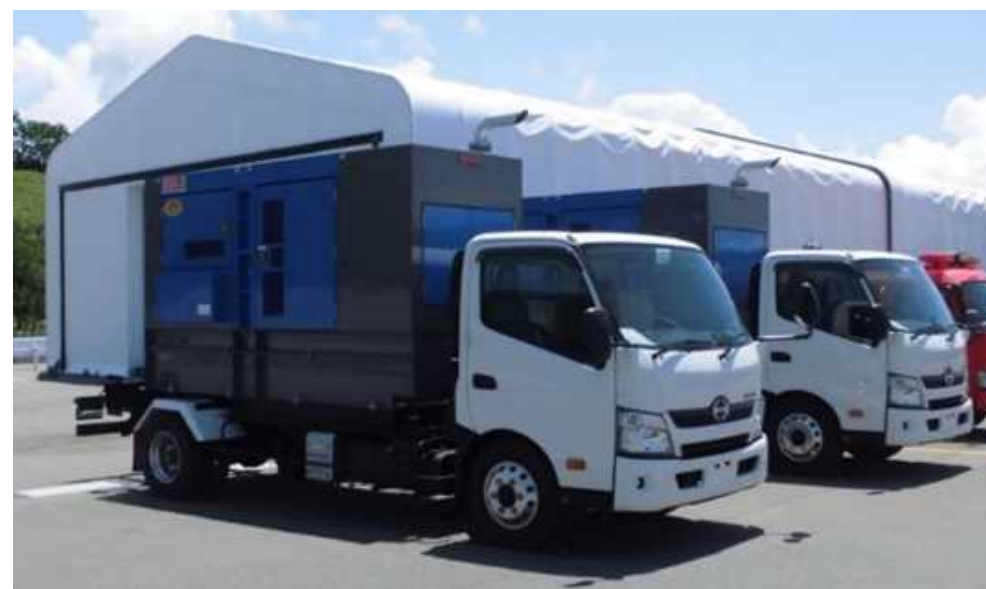
可搬型電源設備 (例)
