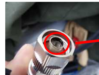
コネクタ接続部の汚れ
