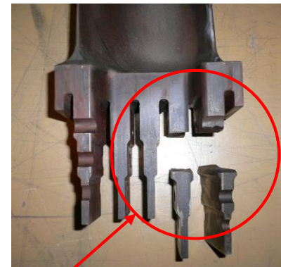
第14段動翼の損傷状況（折損）
