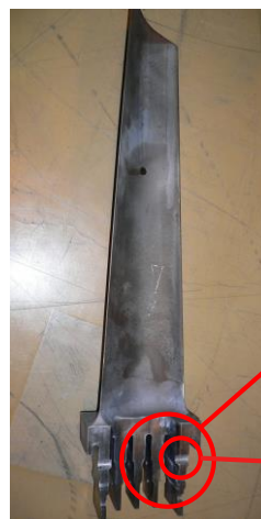
第14~16段 動翼の構造 (付根部:フォーク型)
