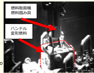
ハンドル変形模擬燃料の吊り上げ状況
