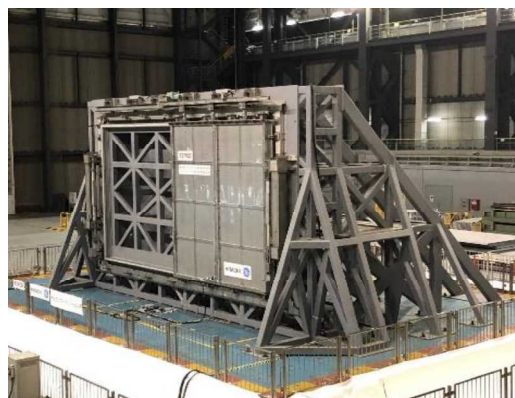
オペロBOP閉止装置加振試験状況
