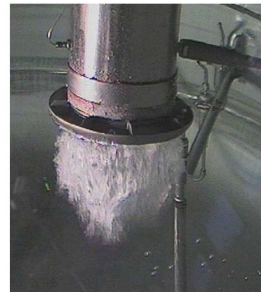
図4-2 蒸気凝縮試験の様子
