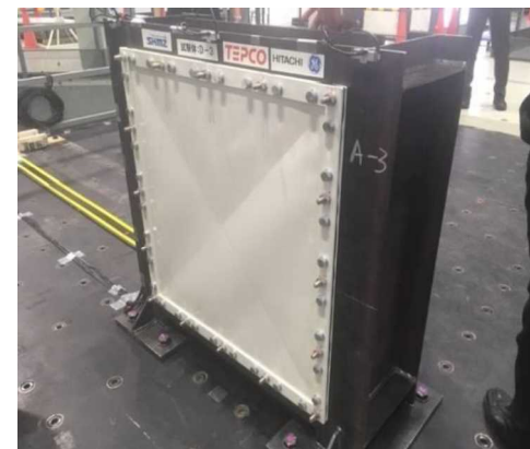
MSトンネル室BOP加振試験状況
