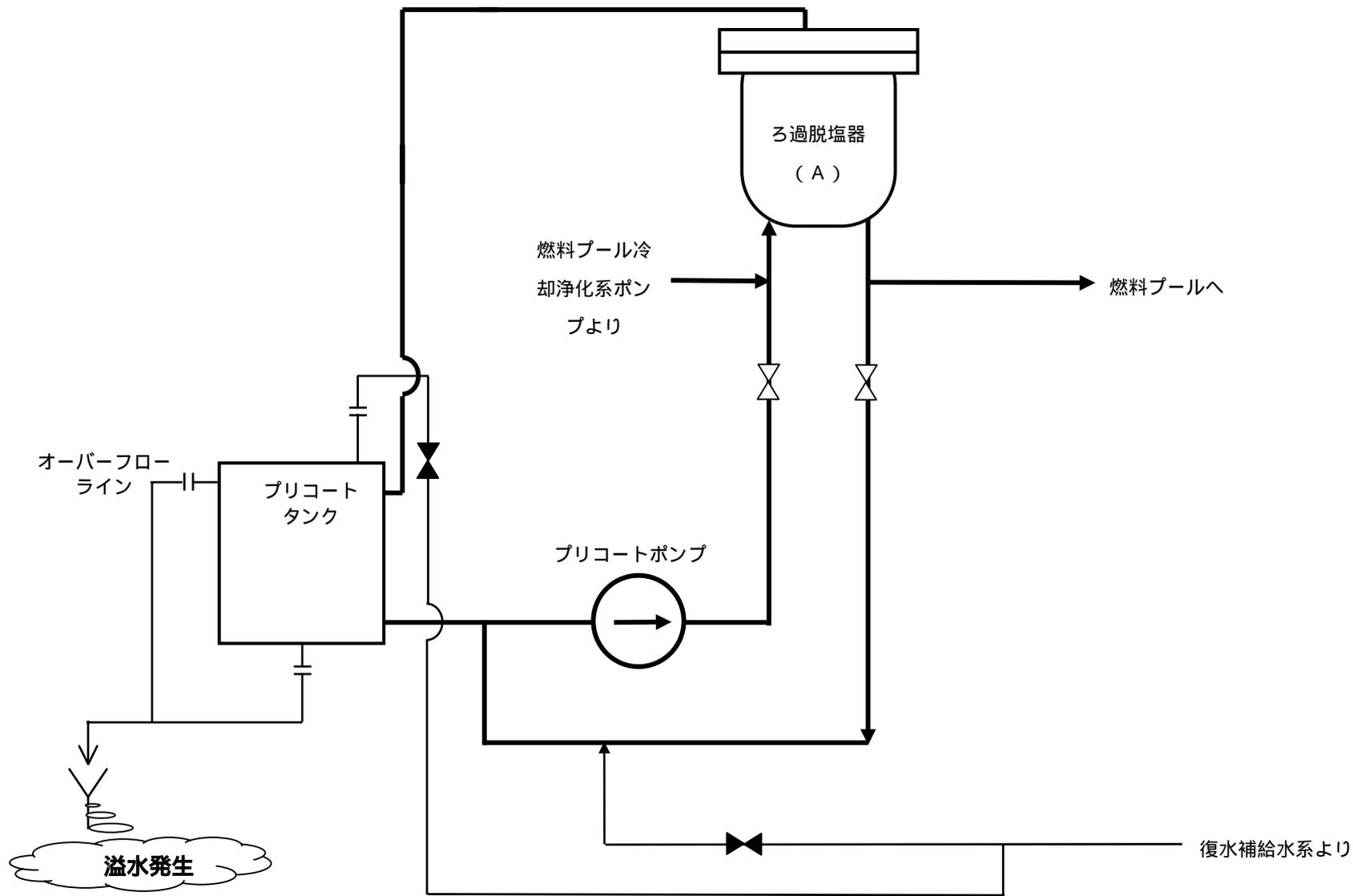
1号機 燃料プール冷却浄化系 ろ過脱塩器 系統概略図
