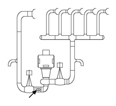
☑:ひびを確認し,取替作業を行う箇所
