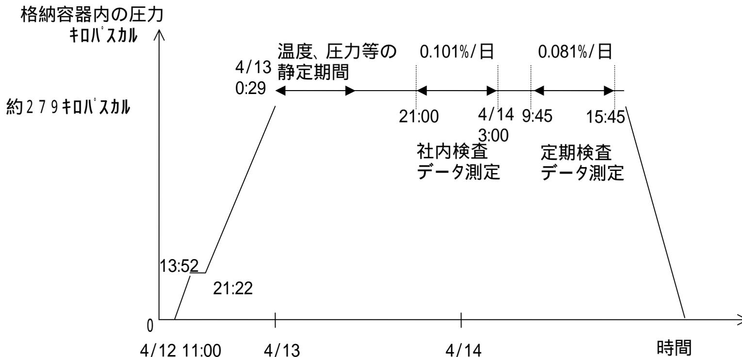
窒素ガスにより格納容器を試験圧力(279キロパスカル)以上まで加圧する。
