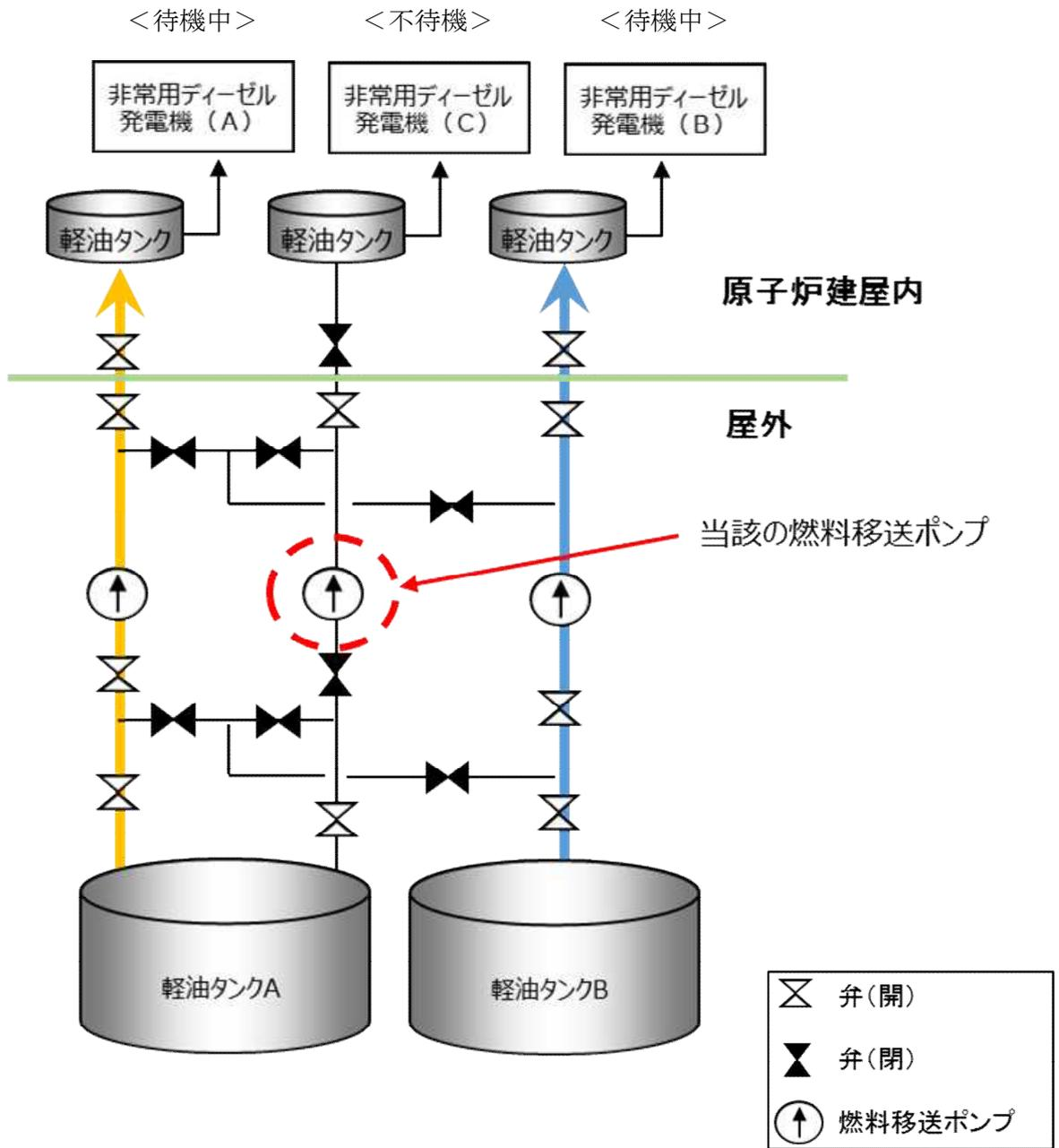
7号機 非常用ディーゼル発電機への燃料移送経路概要図
