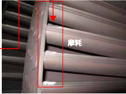
第12段発電機側 湿分分離翼部
